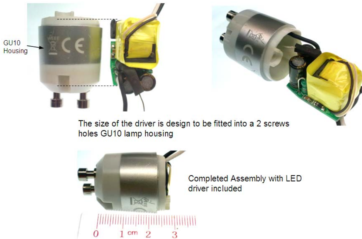
图 2—GU10灯座内部装配后的驱动器。
